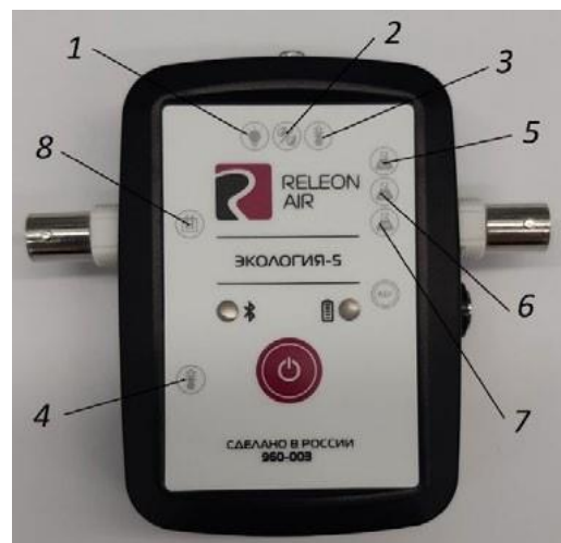
Рис. 2. Мультидатчик по экологии: 1 — освещённость, 2 — относительная влажность воздуха, 3 — температура окружающей среды, 4 — температура растворов, 5 — нитрат-ионы, 6 — хлорид-ионы, 7 — pH, 8 — электропроводность
